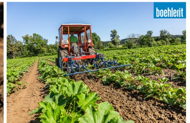
Mit einer neuartigen Spitzenform, der zackigen Schneidkante und dem Biberzahnneffekt sind die Hartmetall-Hackscharen von Boehlerit herkömmlichen Stahlwerkzeugen überlegen.
